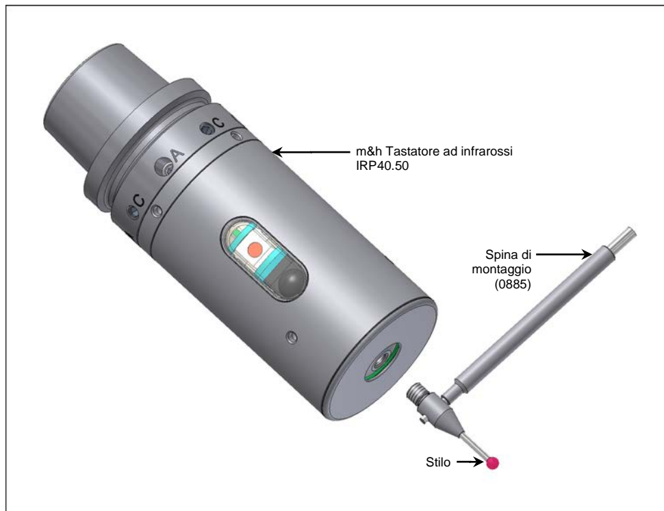
Fig. 6 Sostituzione dello stilo
